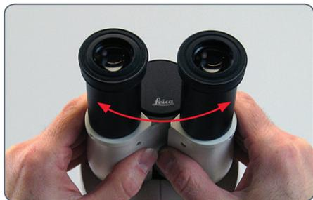
**i** 对于所有瞳距设置，观察镜筒保持恒定的长度。这意味着瞳距的改变不影响齐焦、放大倍率或基于放大倍率的校准。
