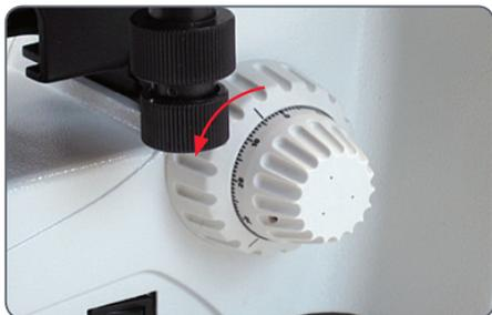
2. 使用粗调旋钮将样品载物台下移至最低位置。
