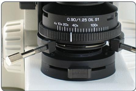
5. 使用载物台支架左侧的聚光镜对焦旋钮，将聚光镜移至最高位置。
