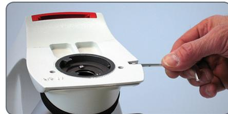
2. 将楔形榫头设为三角架式安装, 并小心地拧紧定位螺栓 (不要过度用力)。恰好使观察镜筒位于显微镜的光轴上即可, 无需考虑选定的旋度。
