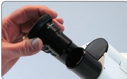
2. 通过用标准型 **Phillips** 螺丝刀 (产品包中未提供) 拧紧镜筒下方的银色螺栓将目镜锁入镜筒中。
