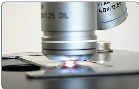
动物镜以消除气泡。然后将油浸物镜放入最终位置，使油滴位于物镜的镜头正面和样品载玻片之间。
